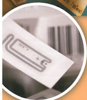
由矽晶片和天線組成的RFID標籤，猶如產品的ID，可透過閱讀器，從伺服器接收產品資訊。
