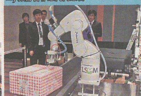
LSCM研發的包裹標籤自動黏貼系統配置深度視像鏡頭以採集3D影像，特別設計的噴射端頭和機械臂，把條碼或射頻識別(RFID)標籤噴射到特定位置上。
