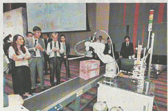
包裹標籤自動粘貼系統可以快速地掃描包裹，找出適當的位置，透過特別設計的噴射端頭和機械臂，把條碼或射頻識別(RFID)標籤噴射到特定的位置。
